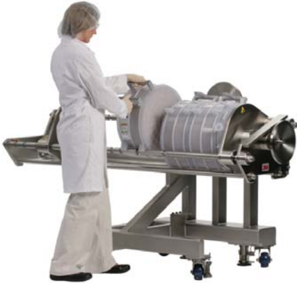
Figura 1: Proceso de carga en el soporte grande de Zeta Plus Encapsulado
